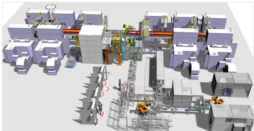
SW modelliert, simuliert, visualisiert, analysiert und optimiert komplexe Fertigungslinien mit Hilfe von Tecnomatix Plant Simulation.
